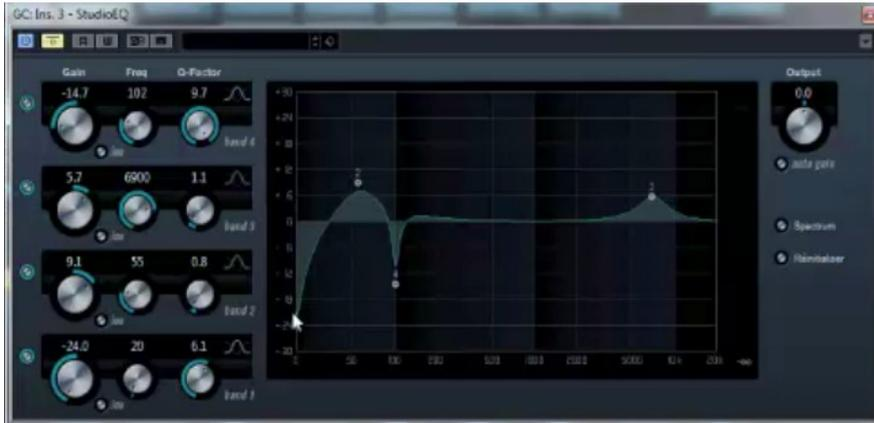
Sur cette piste, je ne veux travailler que l'impact du kick. Pour cela, j'ai coupé mes extrêmes graves, j'ai augmenté ma fréquence aux alentours de 55hz pour avoir de la rondeur puis j'ai également augmenté ma fréquence de quelques db vers 6900 hz pour faire ressortir le claquant de ma batte.
