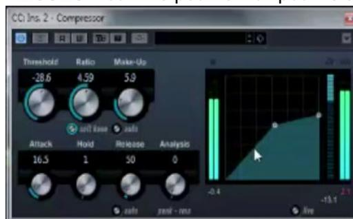
J'ai réglé un Ratio de 4,59 pour que mon compresseur travaille correctement, des attaques de
